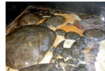
Extrémní tvorba plísní v kontaminovaném systému. V tomto případě je zásadní kompletní sanitace systému biocidním čistěním a mechanické čištění.
